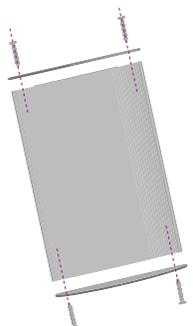
① Des vis fixent les capuchons au profilé. Les capuchons peuvent être en PVC ou en aluminium.
