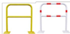
Barrières en acier constituées d'une traverse horizontale et d'un tube acier de 40 mm de diamètre pour une sécurité renforcée, elles sont disponibles en 1 mètre de haut avec platine de fixation de 150 x 150 mm percée de 4 trous de 12mm. Toutes sont proposées en trois largeurs (1, 1,50 ou 2 m).
